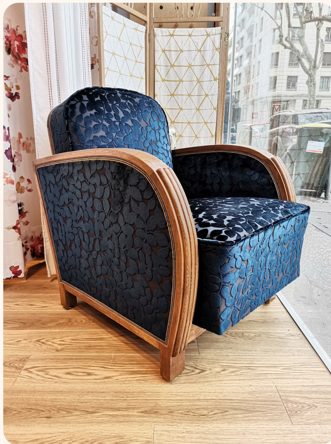
FAUTEUIL ART DÉCO RÉFECTION COMPLÈTE DE L'ASSISE EN CRIN AVEC GUINDAGE SUSPENDU. RÉFECTION PARTIELLE DU DOSSIER. FINITION PASSEPOIL ET GALON PLAT.
